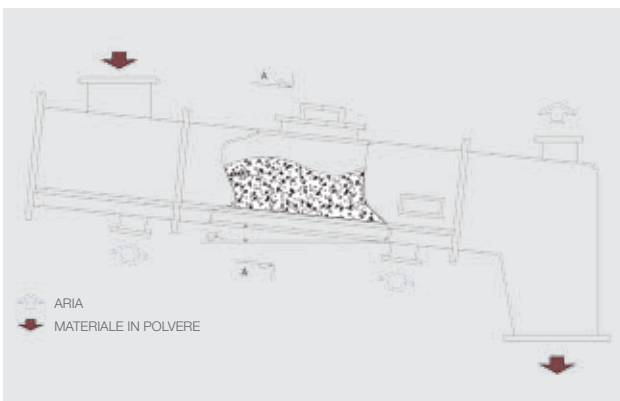
Schema canalette di trasporto polveri
