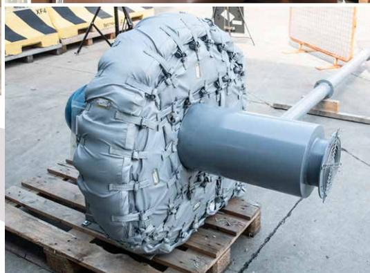
Dal punto di vista tecnico, il vero valore aggiunto di *Prosound-Jacket* è però quello di fornire una **doppia soluzione nel medesimo prodotto**: isolamento acustico e termico contemporaneamente in un materassino **flessibile, leggero, perfettamente adattabile** a qualsiasi geometria e forma.
